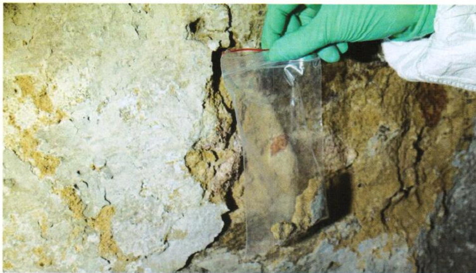
Próbki tynku pobrano do badania na obecność soli. Użyto do tego szczelnie zamykanych woreczków
