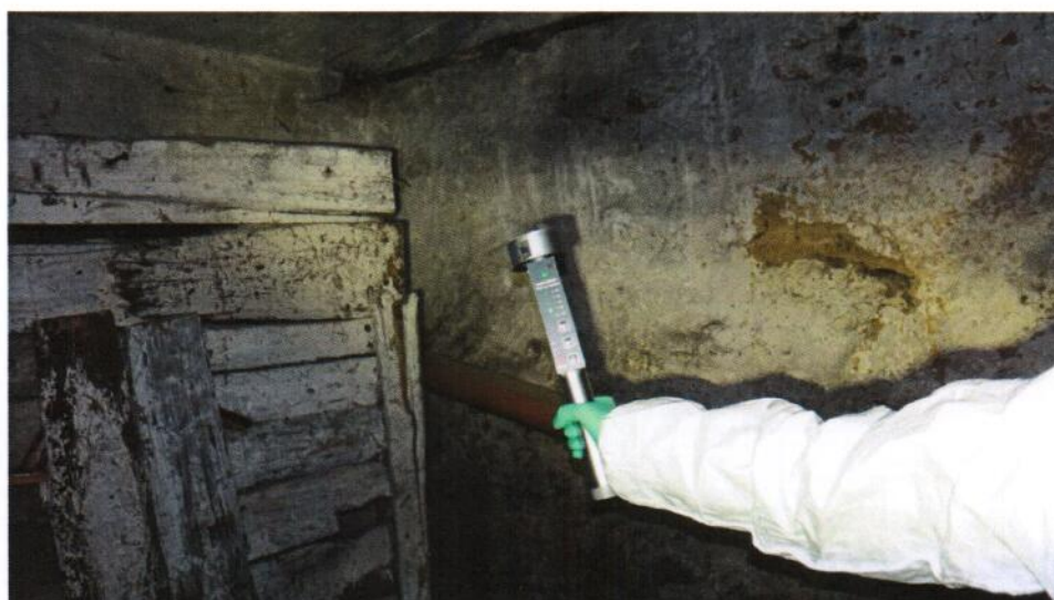
Pobór próby do badania laboratoryjnego grzybów pleśniowych, zawartych w powietrzu
